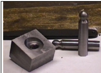
Gabelkopf (man beachte die Schrägbohrung) und Lagerbolzen (noch ohne Gewinde) mit angeschweißter Lagerkugel.
