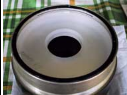
Spiegerrückseite mit Federring und Teflonplättchen
