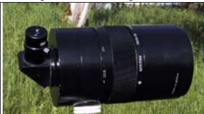
knapp angesetztes Zenitprisma
