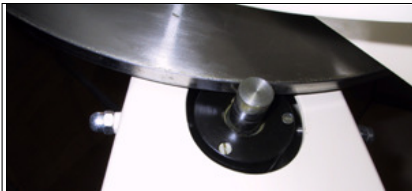
Deklinationsantrieb: Antriebswelle in einem Gabelarm
