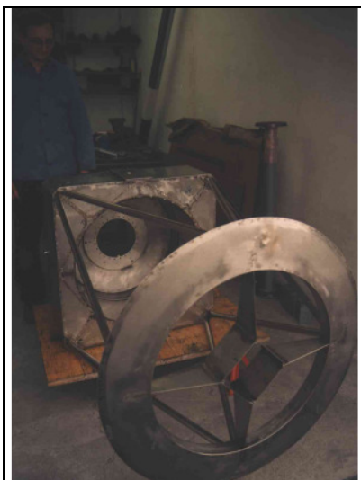
fertiger Tubus aus Edelstahl vom Schweißen leicht „verbeult“ vor dem Lackieren
