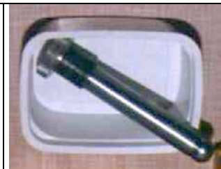
Fertiger Zinkbolzen mit Rändelrad und Kugel
