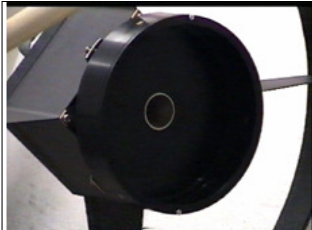
Sekundärspiegelzelle auf Achse aufgeschraubt
