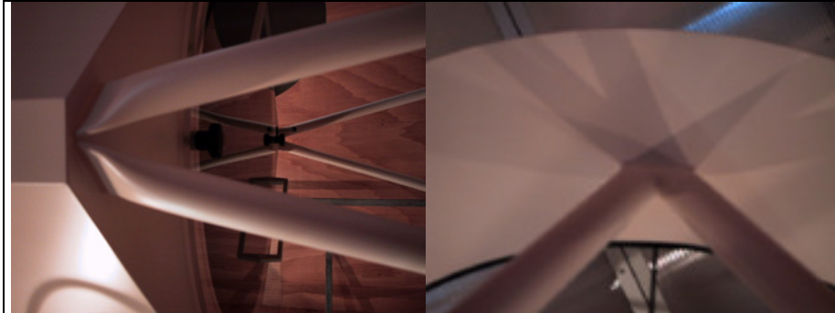
Ansatz der Serrurierstreben am Tragkasten (links) und am Spiderring (rechts)
