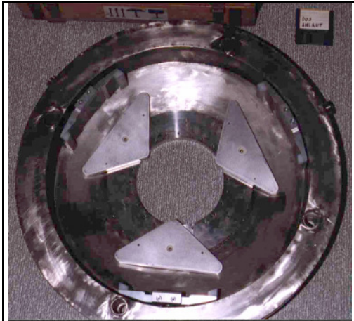
Spiegellagerelemente in der Spiegelzelle
