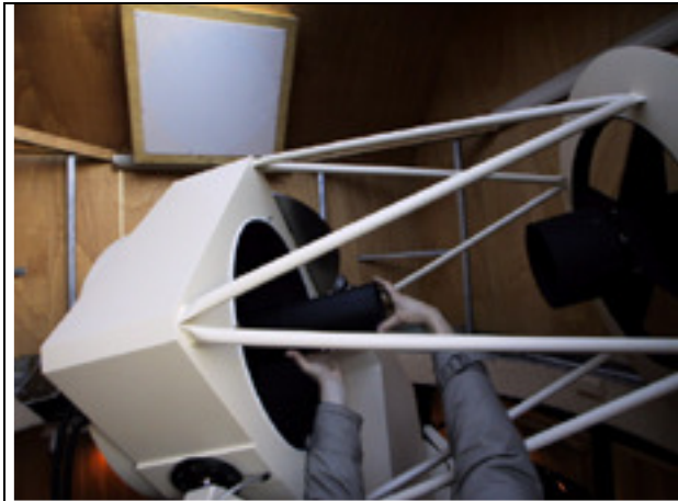
Aufschrauben der Blendenrohrverlängerung
