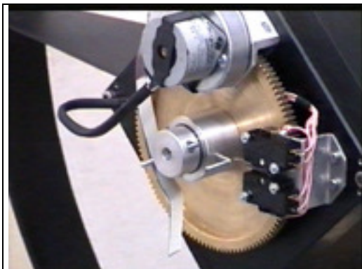
Fokusgetriebe mit Schleppzeiger und Endschalter
